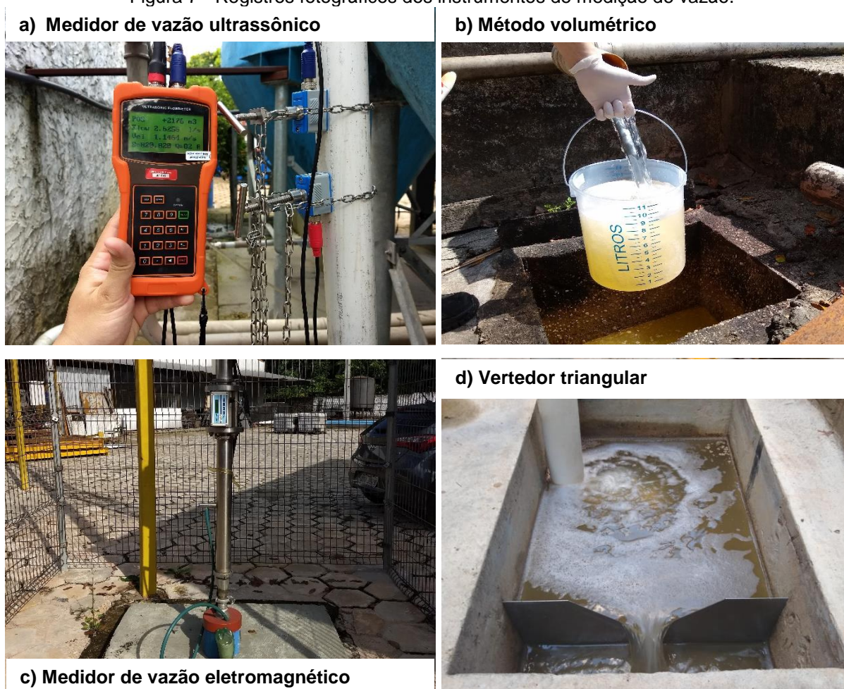
Figura 7 - Registros fotográficos dos instrumentos de medição de vazão.
